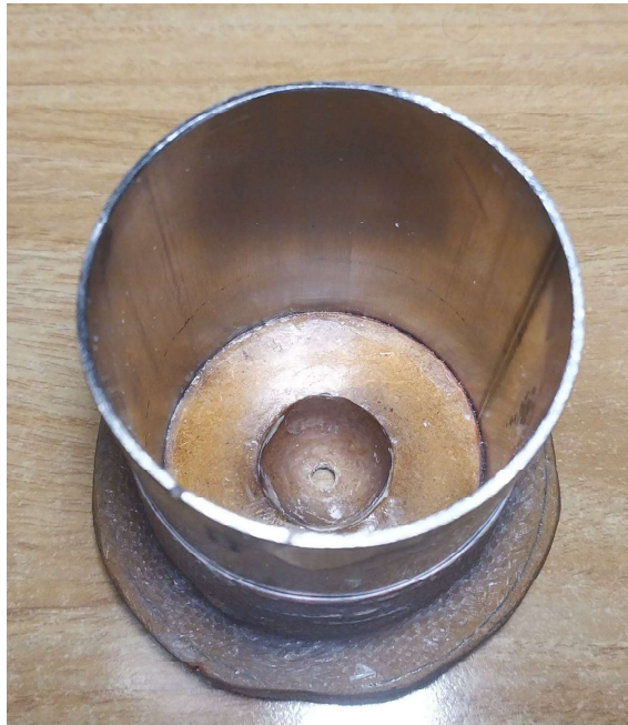
Figura 5.13 Carcasa y base del molde ensamblados.
