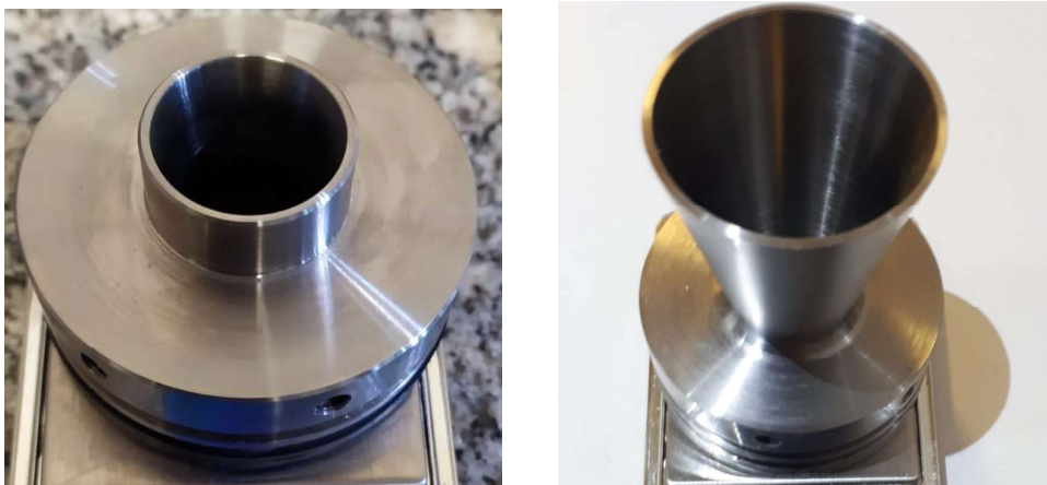
Figura 5.4 Tobera sobre expansionada con rebaje de peso (izquierda), tobera adaptada (derecha).
