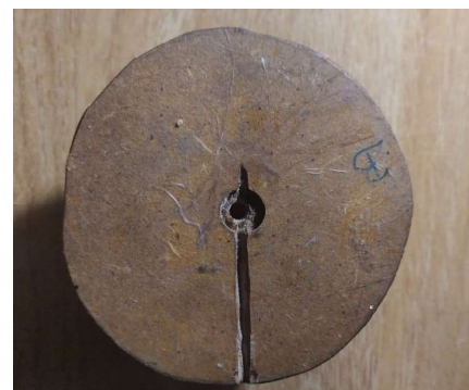
Figura 5.5 Base del molde de propulsante. Vista al derecho (izquierda), vista del revés (derecha).
