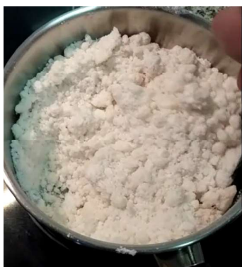
Figura 5.20 Proceso de cocinado, propulsante granulado (60°C).
