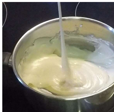
Figura 5.23 Proceso de cocinado, propulsante fundido al punto (110-115°C).
