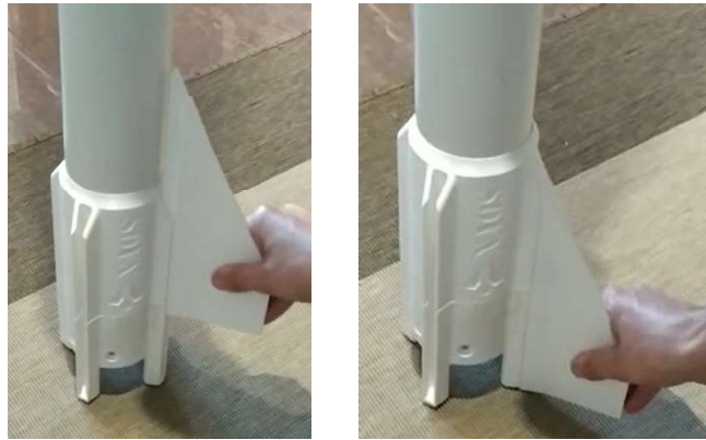
Figura 5.87 Impresión 3D del anillo inferior de aletas.
