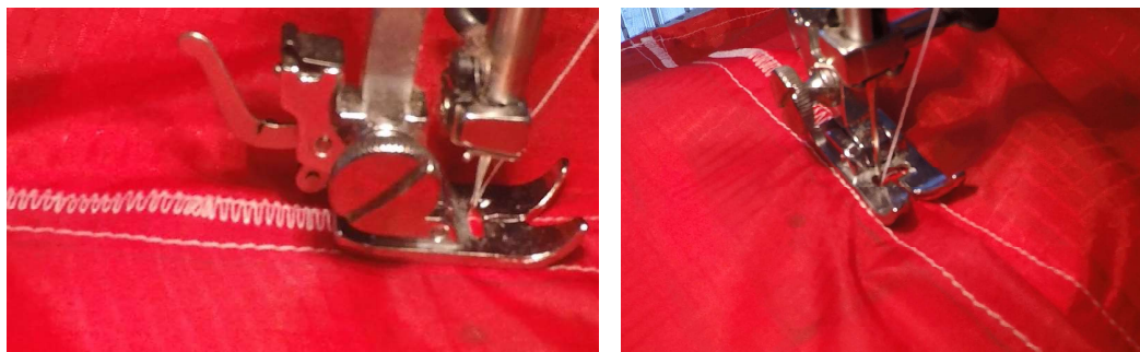
Figura 5.75 Unión de diferentes secciones mediante puntada en zigzag.
