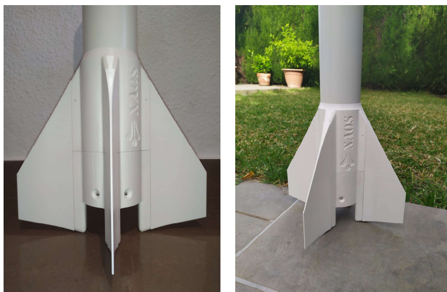
Figura 5.86 Impresión 3D del conjunto de aletas y anillo.
