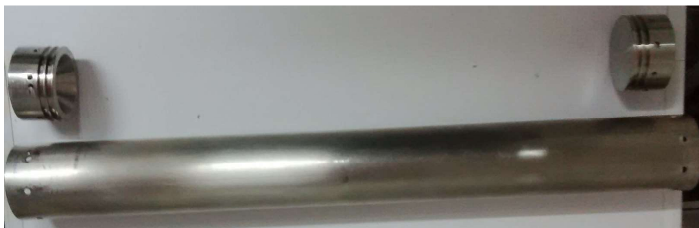
Figura 5.1 Motor cohete de NAOS. Carcasa, cierre posterior y tobera sobre expansionada.
