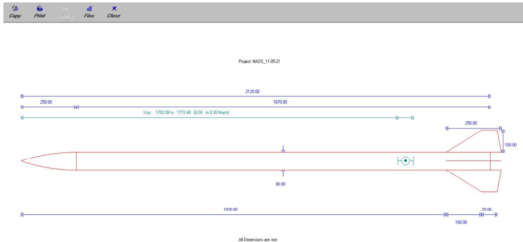
Figura 4.59 Esquema de cotas y Centro de Presiones de Aerolab.
