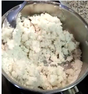
Figura 5.21 Proceso de cocinado, propulsante granulado compacto (70°C).
