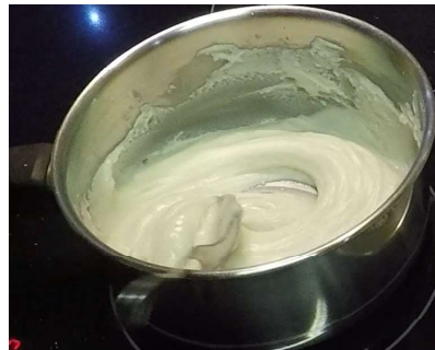
Figura 5.22 Proceso de cocinado, propulsante fundido (80-90°C).
