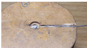
Figura 5.25 Anclaje entre vástago y base del molde.
