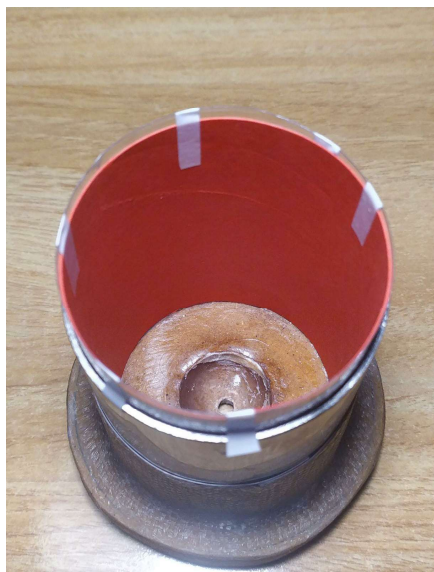
Figura 5.15 Cartulina de inhibición del grano integrada en el molde.
