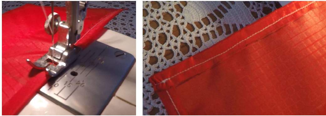
Figura 5.73 Pliegue de bordes con puntada recta.
