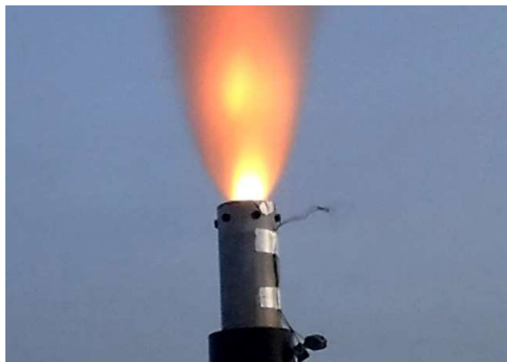
Figura 3.29 Tobera de NAOS Sub-Expansionada (comportamiento real).
