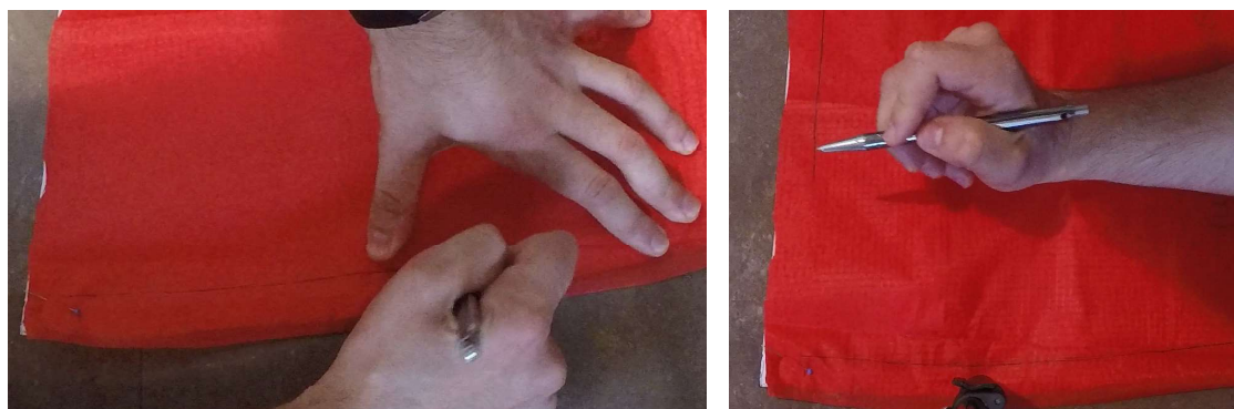
Figura 5.71 Calcado de la silueta interior del patrón sobre la pieza recortada de tela.
