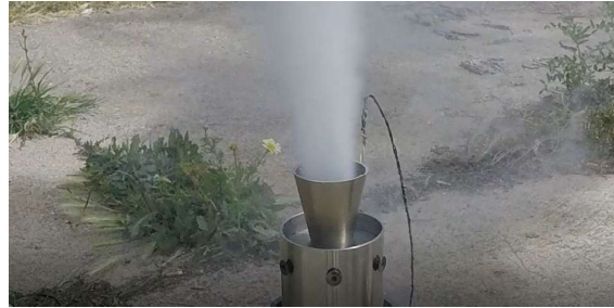
Figura 3.20 Tobera de NAOS Sobre-Expansionada (comportamiento real, ensayo en banco de Coheteros).
