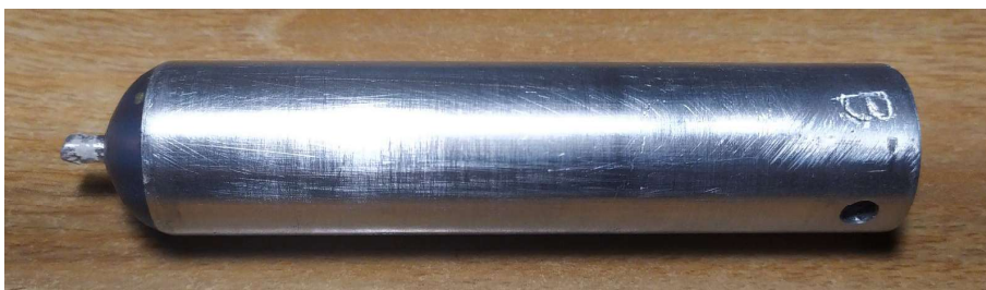
Figura 5.6 Vástago del molde de propulsante.
