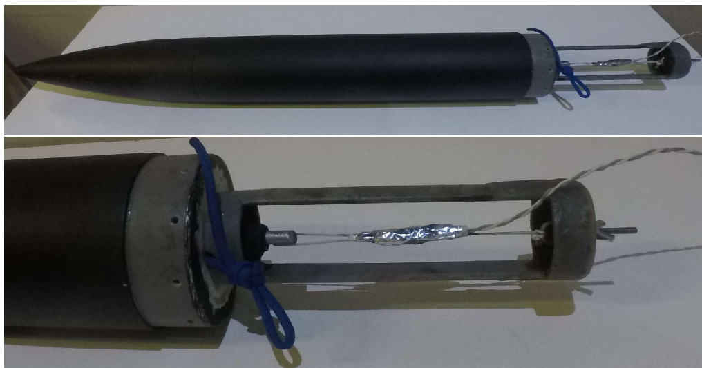
Figura 5.60 Sistema de Liberación y Recuperación armado ON.
