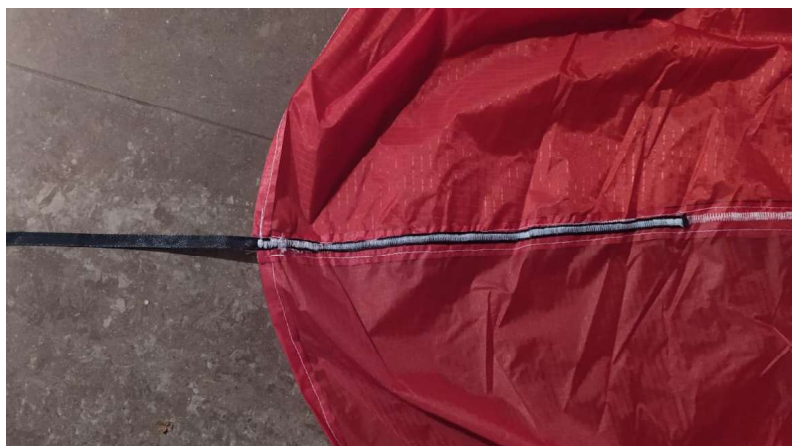
Figura 5.77 Cinta de raso unida al paracaídas mediante puntada en zigzag.
