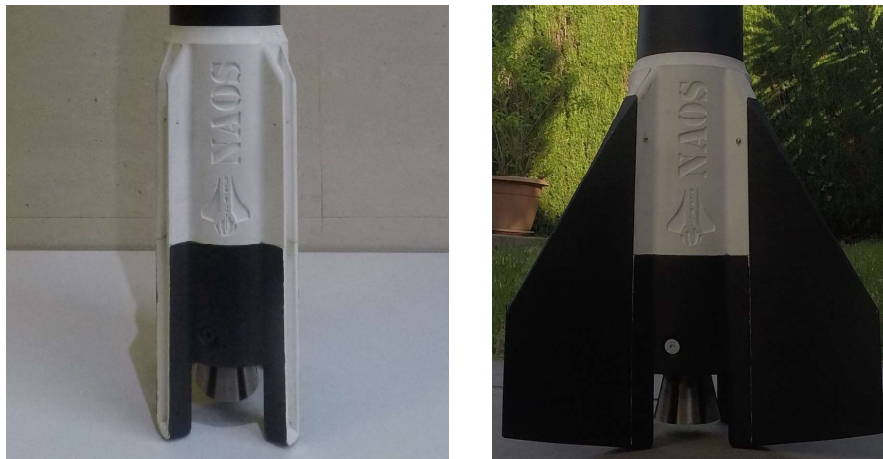
Figura 5.88 Aletas de NAOS con capa de pintura.
