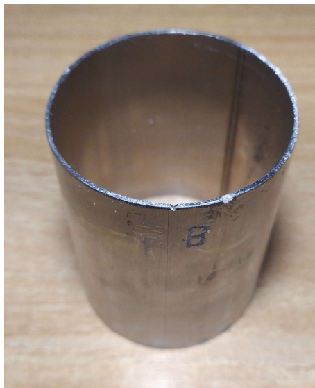
Figura 5.7 Carcasa exterior del molde de propulsante.
