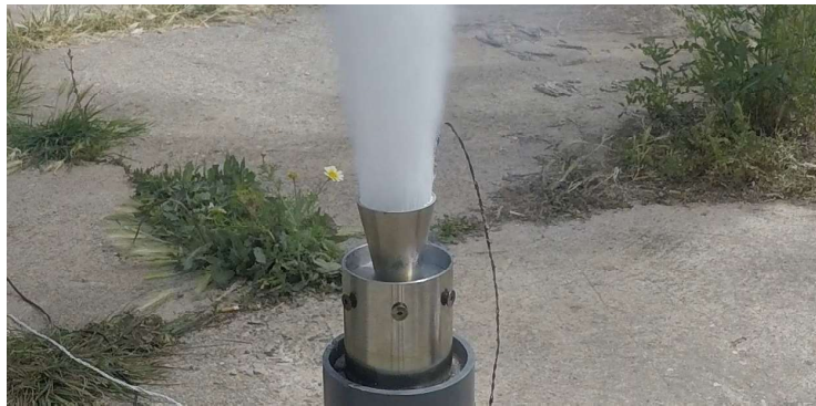
Figura 3.26 Tobera de NAOS Adaptada (comportamiento real, ensayo en banco de Coheteros).
