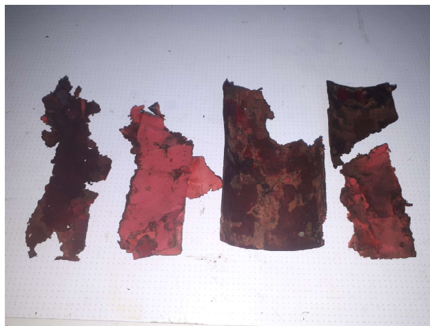
Figura 6.35 Restos de la inhibición tras el ensayo de Diciembre de 2020.
