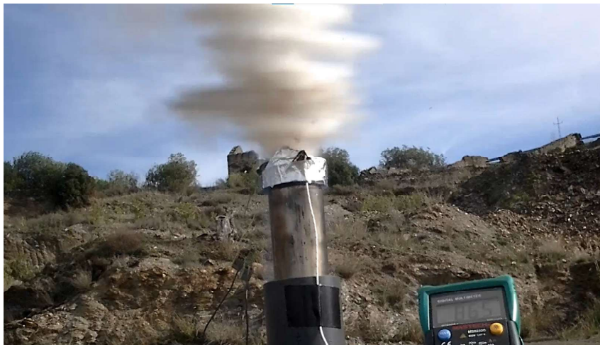
Figura 6.12 Ondas de choque producidas por el taponamiento de la tobera.
