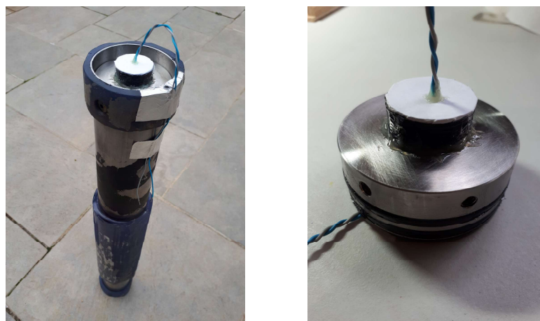
Figura 6.27 Membrana de papel en la tobera del motor cohete.
