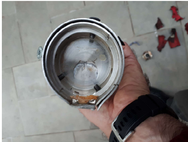
Figura 6.38 Aspecto del cierre posterior tras el ensayo de Diciembre de 2020.
