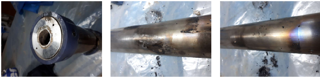
Figura 6.13 Decoloración de la superficie de acero inoxidable del motor cohete tras la prueba de Diciembre de 2018.
