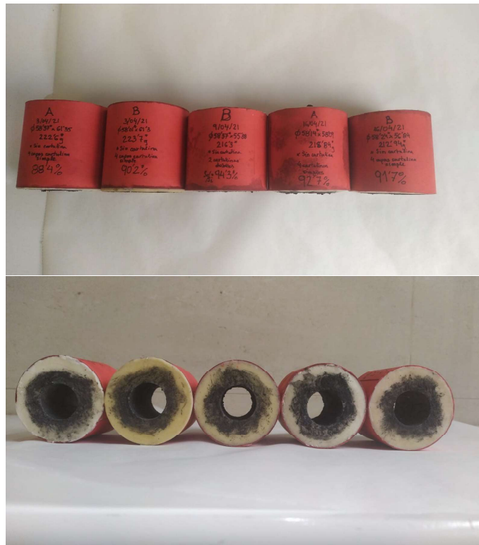
Figura 6.43 Carga de 5 granos cortos de propulsante para el ensayo en banco de Abril de 2021 .
