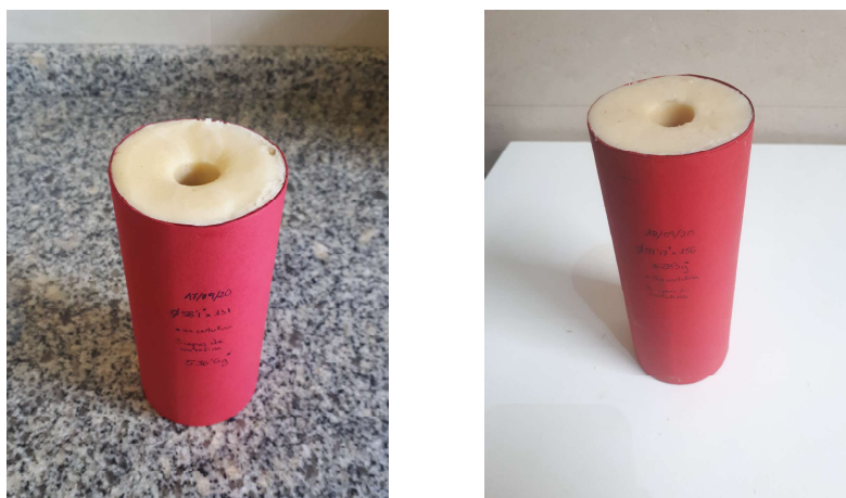
Figura 6.16 Carga de 2 granos largos de propulsante para el ensayo en banco de Septiembre del 2020 .
