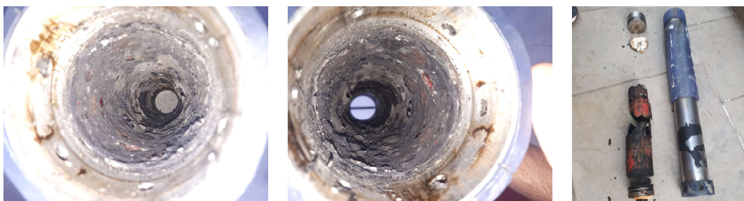
Figura 6.24 Restos de inhibición tras la prueba en banco de Septiembre de 2020.
