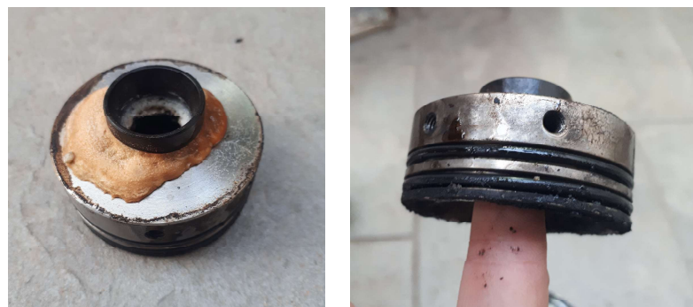
Figura 6.26 Estado de la tobera tras la prueba en banco de Septiembre de 2020.
