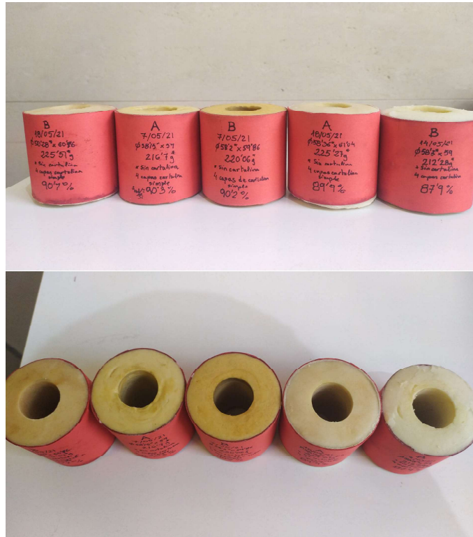
Figura 6.70 Carga de 5 granos cortos de propulsante (sin pintar con pólvora negra) para el Lanzamiento de NAOS de Mayo de 2021 .
