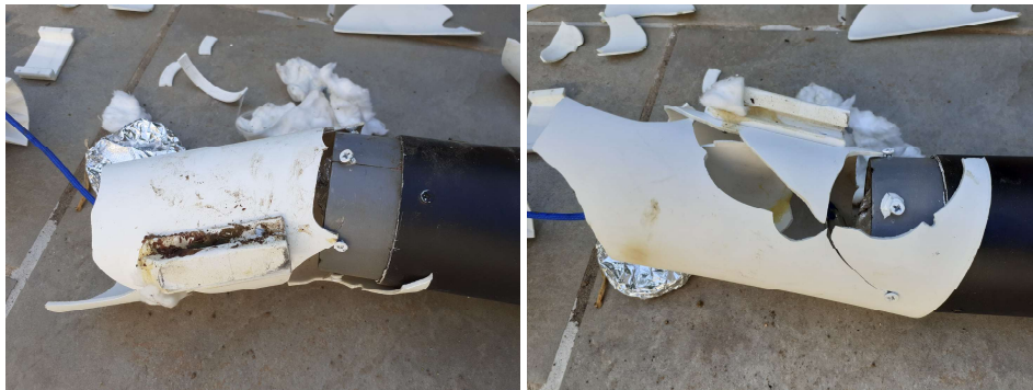
Figura 6.83 Modo de rotura del acoplamiento entre secciones.
