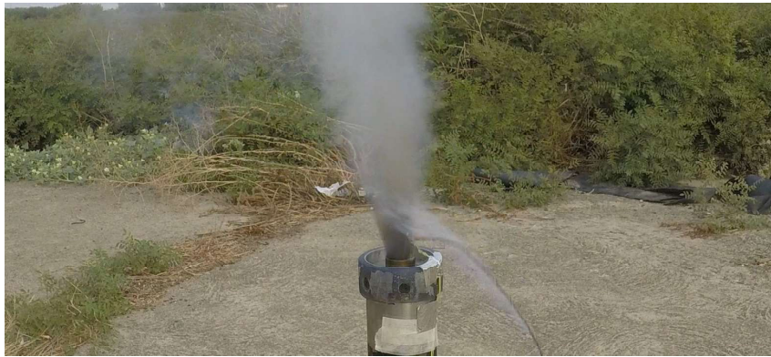
Figura 6.23 Fotograma de eyección de ignitor del ensayo de Septiembre de 2020.
