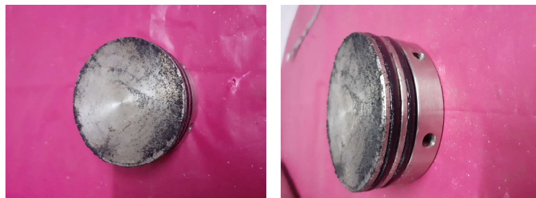
Figura 6.59 Aspecto del cierre posterior tras el ensayo de Abril de 2021.
