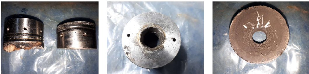
Figura 6.14 Tobera y cierre posterior tras la prueba en banco de Diciembre de 2018.
