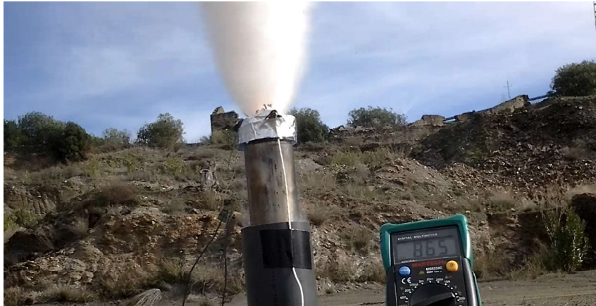
Figura 6.11 Fotograma del ensayo de Diciembre de 2018 (tobera sub expansionada, ondas de expansión).
